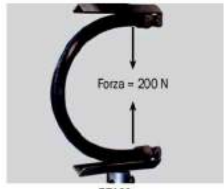
PE100 S-ONE Test di flessione su tubo DN32 secondo UNI EN ISO 10619-1
