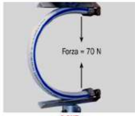
PE100 S-ONE Test di flessione su tubo DN32 secondo UNI EN ISO 10619-1
