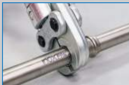
Controllo della pressatura
